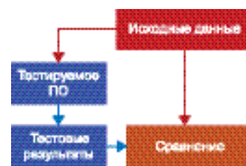
Рис. 2 Тестирование ПО методом моделей исходных данных
