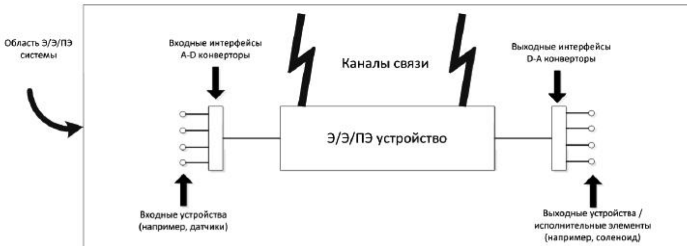
Рисунок 3 - Э/Э/ПЭ система: структура и терминология
