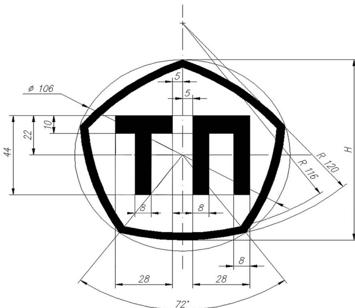
Начертание и способ построения знака высотой  $H=20$  мм должны соответствовать указанным на чертеже.
